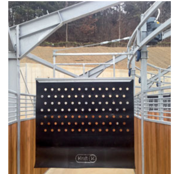
Stabile Führung der Trenngitter am Innenring
