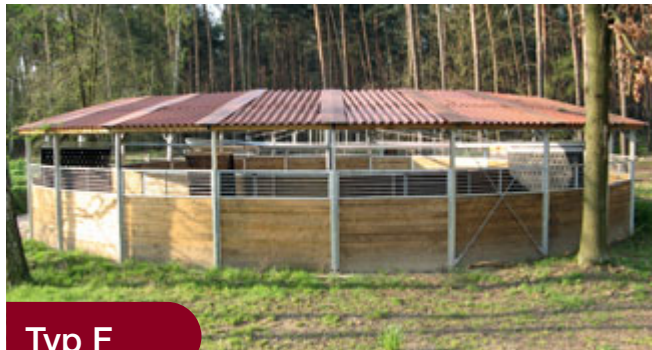
Typ F waagrechte oder senkrechte Fichten-Bohlen, 40 mm, gehobelt, Nut und Feder geschlossen bis 1,5m, mit verzinktem Aufsatzrahmen von 1,5–2,0 m
