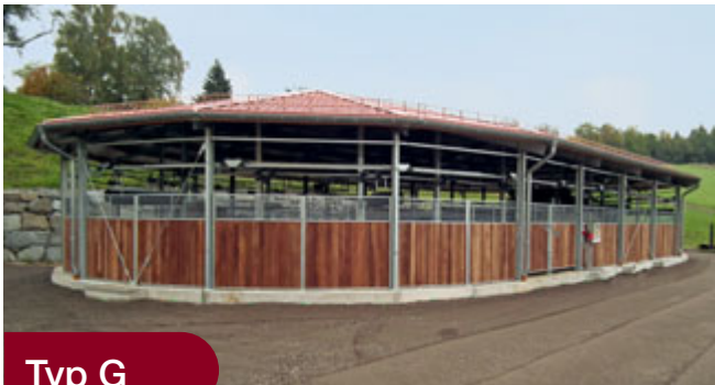
Typ G senkrechte Hartholz-Bohlen, 40 mm, gehobelt, Nut und Feder geschlossen bis 1,5m, mit verzinktem Aufsatzrahmen von 1,5–2,0 m
